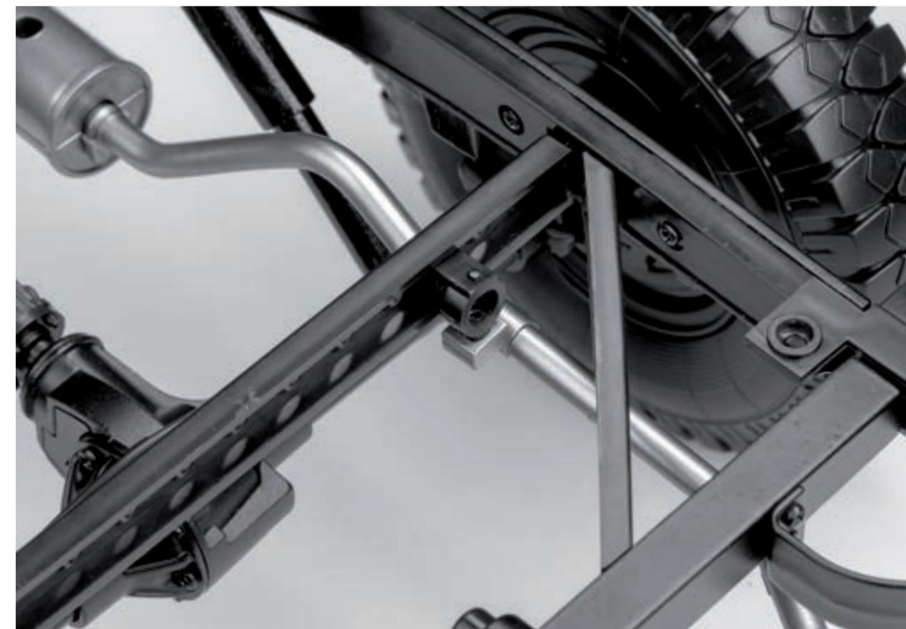
**Шаг 8.** Для окончательной фиксации выпускной системы закрепите кронштейн выпускной трубы на тяге задней подвески трубы глушителя (возле поперечины №4 рамы). Для скрепления деталей используйте винт 2,0×4 (EP).
