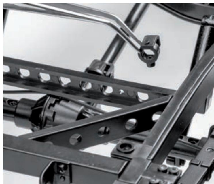
**Шаг 5.** Закрепите тягу задней подвески трубы глушителя на поперечине рамы №4. Для этого поместите тягу подвески глушителя с задней стороны поперечины (с правой стороны) и закрепите ее винтом 1,7×4 (AP). Свободное отверстие для крепления трубы глушителя должно располагаться снизу.
