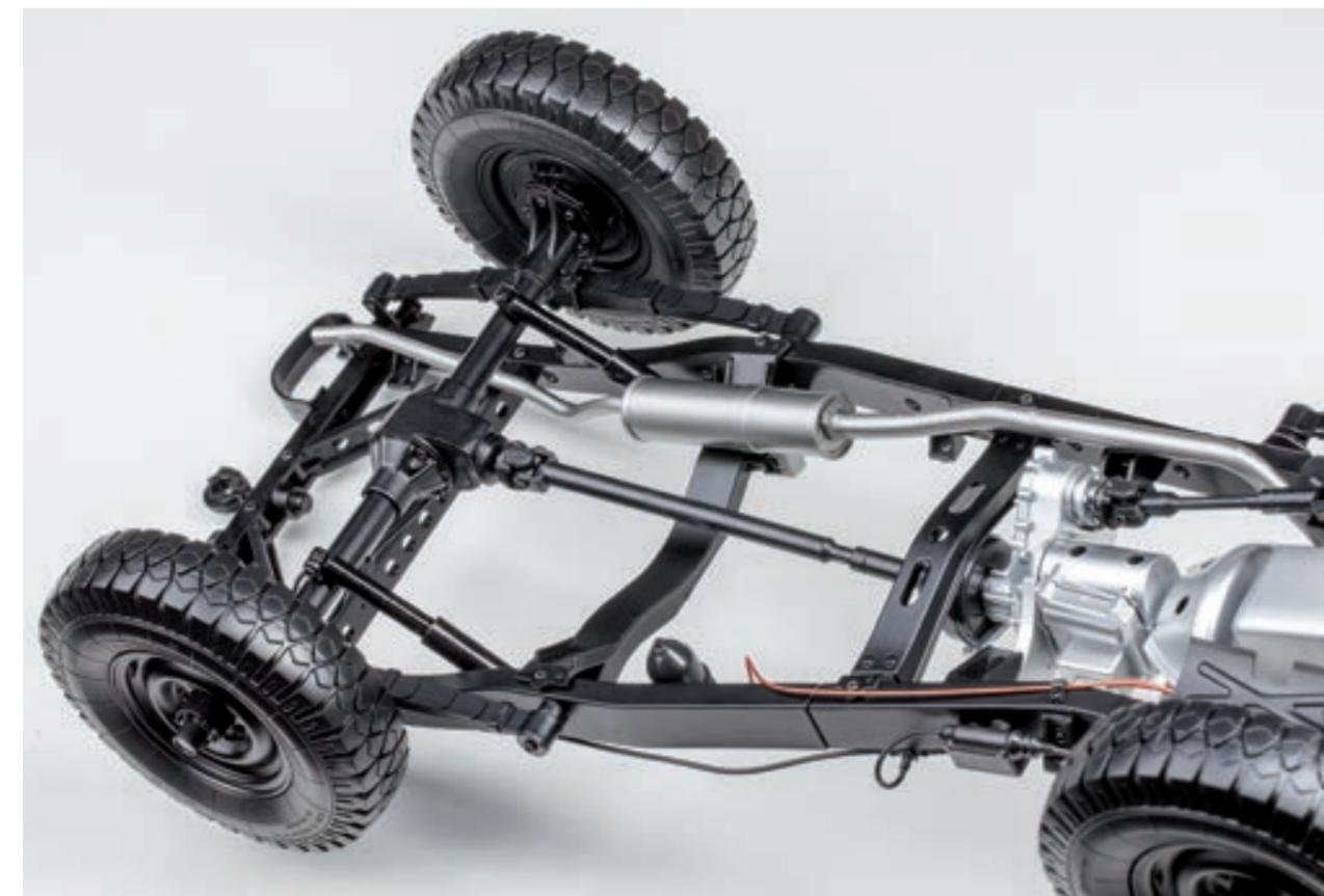
**Шаг 6.** Разместите собранную выпускную систему на раме модели. Передний конец приемной трубы должен пройти между правым лонжероном рамы и передним карданным валом. Выпускная труба глушителя должна располагаться между задними поперечинами рамы и задним мостом. Закрепите приемную трубу на выпускном коллекторе двигателя. Плотнo прижмите детали друг к другу.
